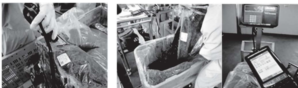
写真 3 開梱ラベルを読んで計量し、小分け作業を行う様子
